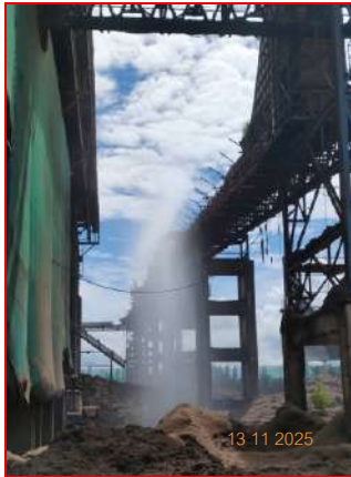
ภาพที่ 2.2-12 การฟุ้งละอองน้ำบริเวณลานกองขานอ้อย
